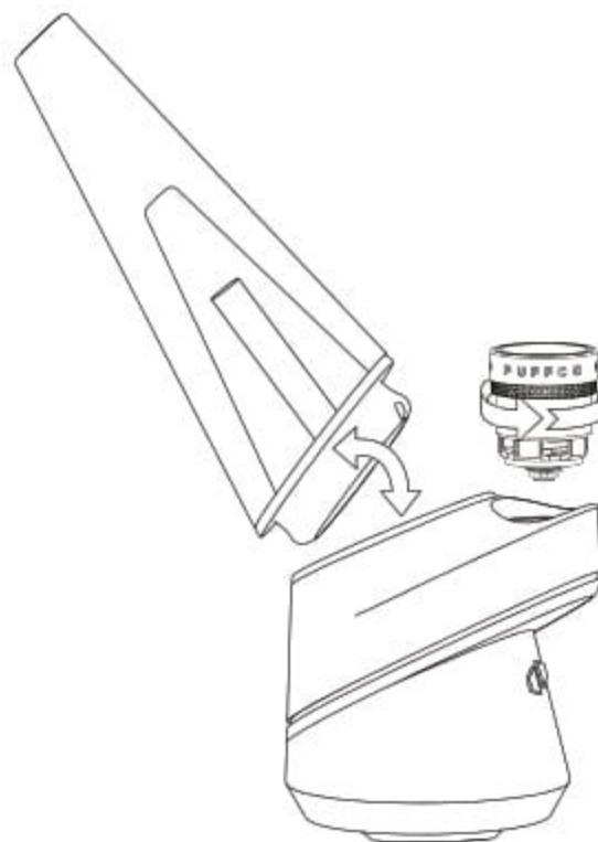
**Подготовка:** Снимите стеклянную насадку перед тем как отвинтить и заменить атомайзер (не завинчивайте сильно туго, не применяйте грубую силу).
