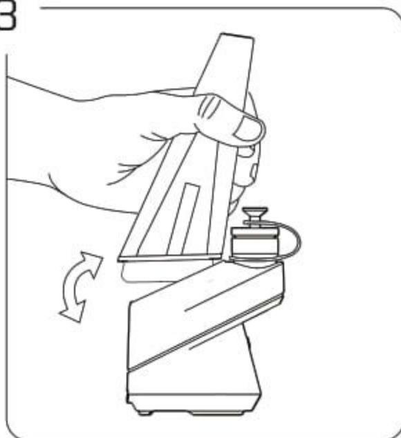
Шаг 3: Совместите входное отверстие насадки с атомайзером. Аккуратно вставьте сначала переднюю часть, а затем заднюю часть насадки в базу.
