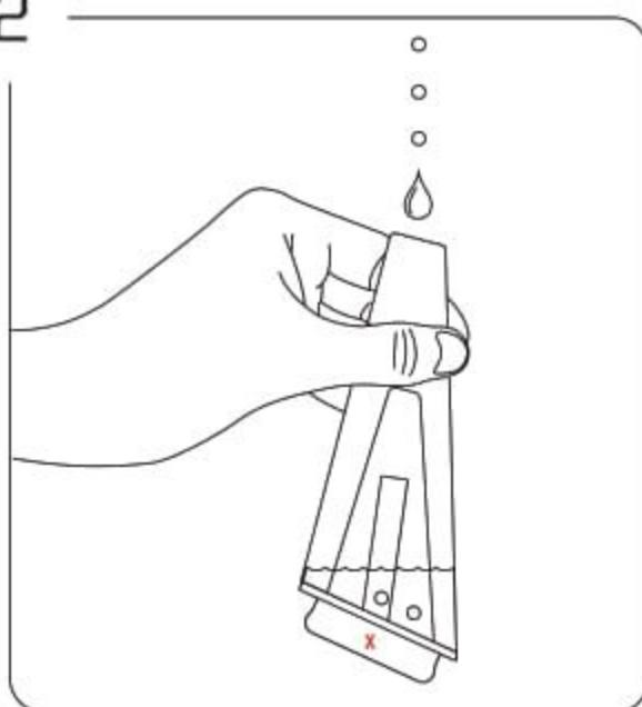
Шаг 2: Наполните стеклянную насадку водой чуть выше отверстий для воздуха. Не наполняйте насадку, когда она присоединена к базе.
