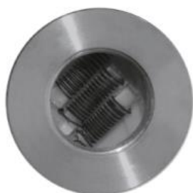
Камера с тремя кварцевыми спиралями
