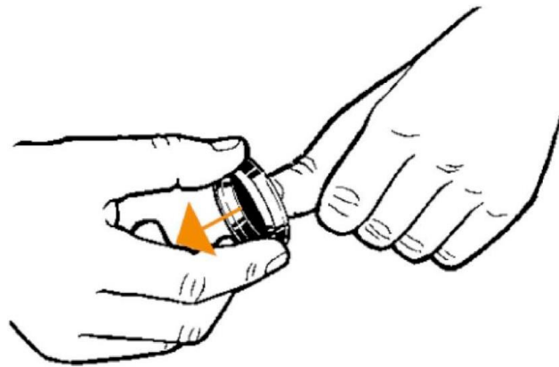
Извлечение нижнего фильтра
