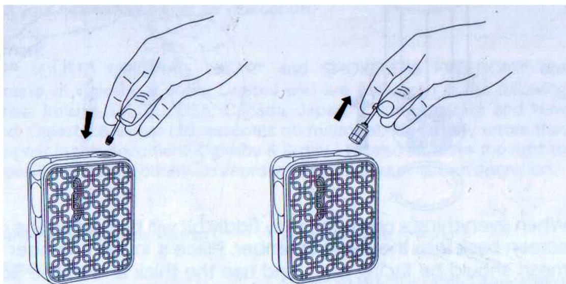
Если рабочая камера не отсоединилась от корпуса WISPR-2, вкрутите в нее инструмент для извлечения рабочей камеры (10) и вытащите ее из корпуса.
