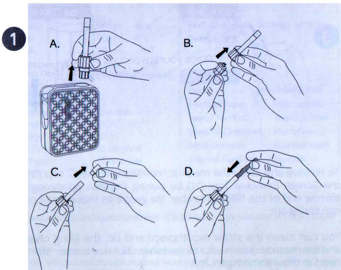
Отсоедините гибкий мундштук (1) и рабочую камеру (6) от корпуса и разъедините их. Теперь снимите кончик мундштука (5). Используя инструмент для чистки (12), вычистите мундштук изнутри.
