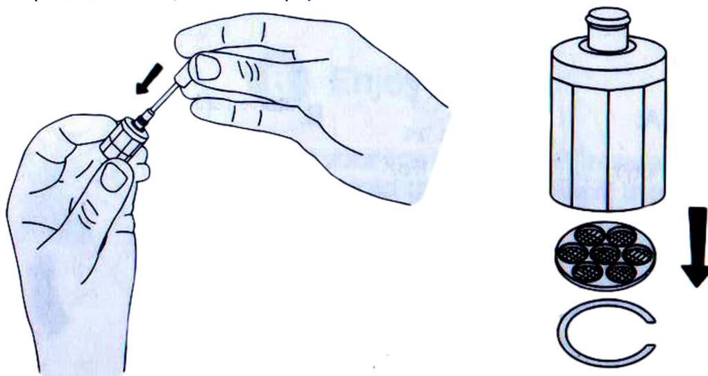
Чтобы вытащить и почистить фильтровальную сетку (8) и С-образный зажим (9), используйте устройство для извлечения сетки (11), вставив его тонкий конец в узкое отверстие рабочей камеры и выталкивая им сетку. Будьте аккуратны, потому что эти маленькие части могут выскочить.
