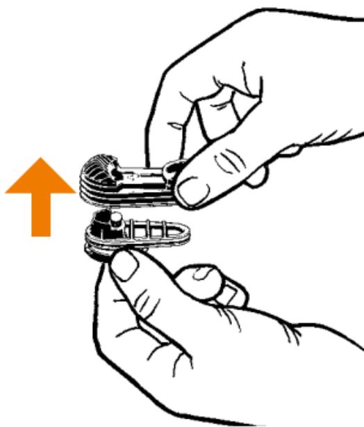
*Снятие крышки охлаждающего блока с основания*
