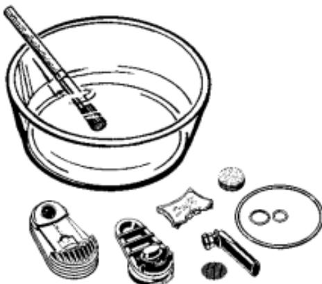
*Чистка разобранного охлаждающего блока вручную*
